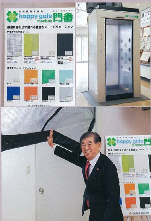
上右/コンパクトで工事が簡単な自立型門番。非接触スイッチも標準装備。エアシャワーなど衛生設備との組み合わせがコロナ禍で注目されている。上左/シートはバリエーション豊富。透明性や採光性、防虫、帯電防止不燃など様々なニーズに応える。下/動作中に衝突しても自動的に復元。停電時も下端部を持ち上げれば通り抜けられる超安心構造。
